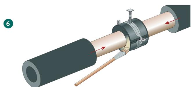
Beide Rohrträgerseiten sowie die Schlauch-Schnittflächen dünn mit Kautschuk-Kleber (Hersteller-geprüft) bestreichen und nach Ablüften zusammenkleben ...
