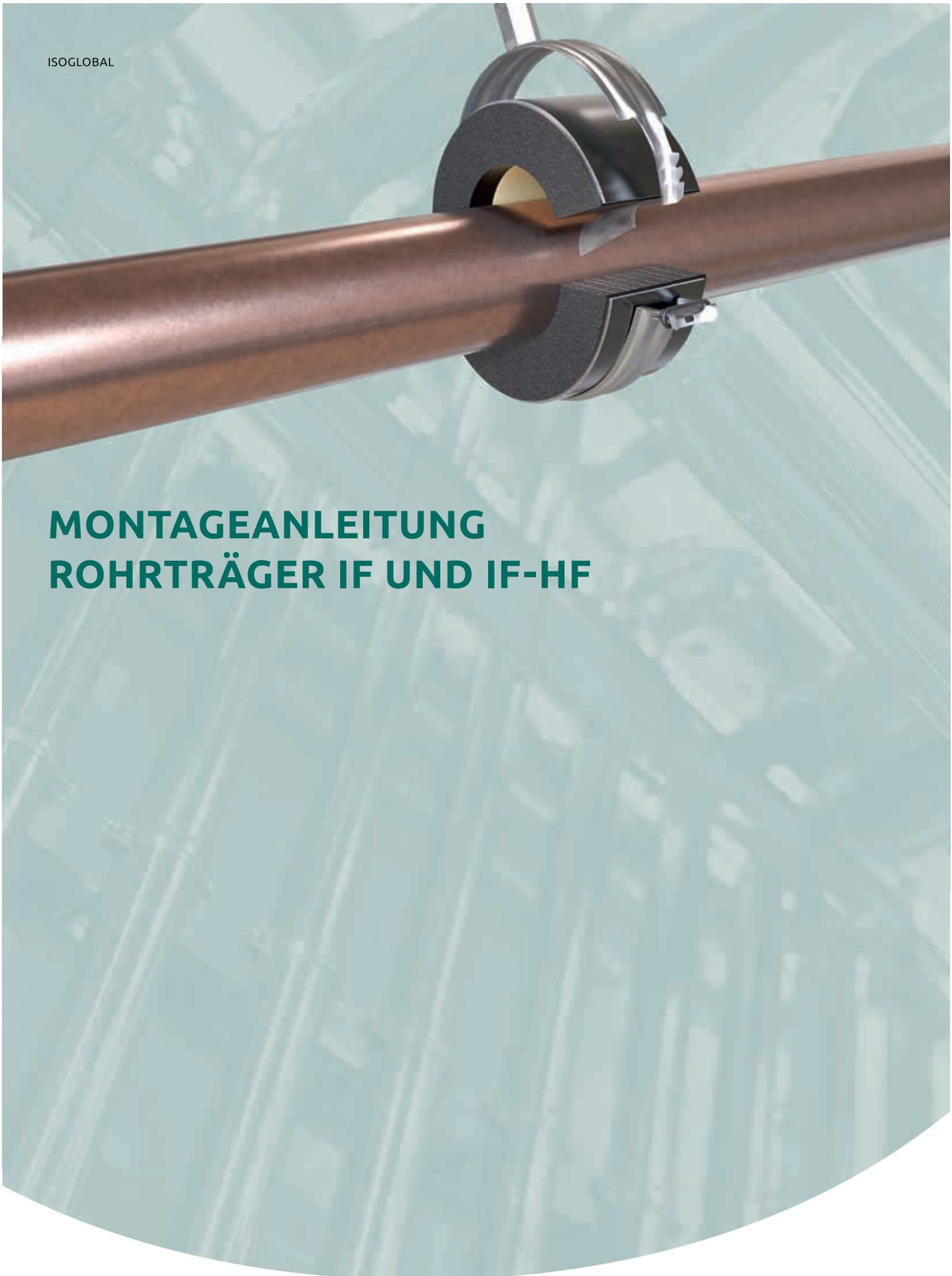
Der Rohrträger IF besteht aus einem innenliegenden Auflageelement aus besonders druckfestem PIR-Schaum, eingebettet in einem Mantel aus Eurobatex Kautschuk. Als äußere Dampfbremse sind auf dem Außenmantel zwei stabile Aluminiumbleche angebracht.
