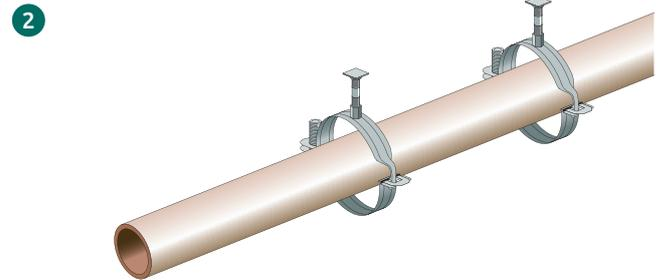
Rohr in die Schellen einlegen und positionieren ...
