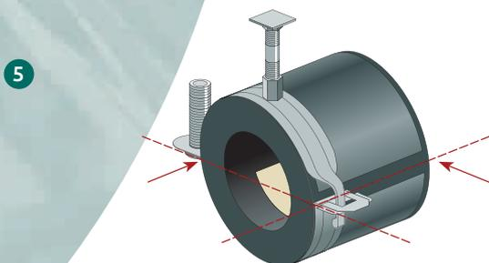
Die Naht der einseitigen IF-Rohrträgeröffnung liegt immer horizontal, unabhängig von der Position der Schellenverbindungen ...
