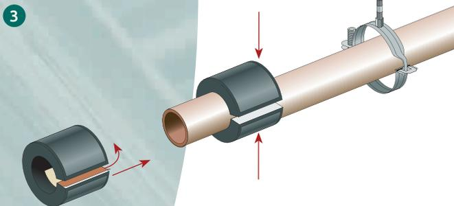
Rohrträger IF – Schutzfolien von Klebeflächen abziehen, um das Rohr fixieren und zusammenkleben ...
